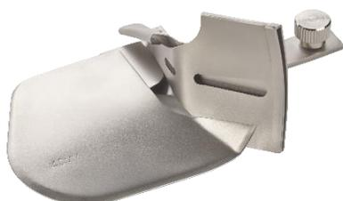
Mit dem Einfachfalten-Bandeinfasser lassen sich Stoffkanten und Halsausschnitte perfekt mit Band einfassen. Das ungefaltete Band wird durch die angebrachte Führungsschiene eingeführt, auf der oberen Seite umgeschlagen während die Unterseite offen bleibt und mit einem Coverstich versäubert wird. Für den perfekten Look kann das Band auch selbst angefertigt werden. Bänder von 40 mm Breite ergeben eine fertige Breite von ca. 10 mm. Zur Anwendung des Bandeinfassers wird ein Zubehörhalter benötigt.
