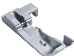
Mit dem Perlen- und Paillettenfuss können Perlen- und Paillettenschnüre von max. 6 mm Durchmesser schnell und einfach aufgenäht werden. Er wird für schöne Abschlüsse an Stoffkanten oder für Dekoration an Flachnähten verwendet. Die Rille an der Fussunterseite und der seitliche Führungskanal erfassen Perlen- und Paillettenschnüre optimal, sodass sie ohne Verrutschen vernäht werden können. In Kombination mit dem rechten Nahtführungslinial als Führungshilfe gelangen die Nähte besonders exakt.
