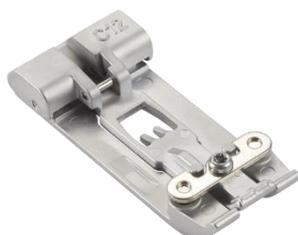
Für Nähte, Säume, Einfassungen und dekorative Cover- oder Kettenstichnähten entlang unebener Stofflagen. Die gefederten seitlichen Fusskanten führen den Stoff bei Bandeneinfassungen, bei Säumen mit Gummiband oder beim schmalkantigen Absteppen.
