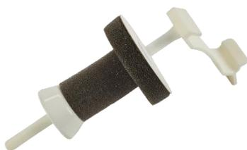
Dieser horizontale Garnrollenhalter hält Tellerspulen mit Parallelwickel sowie konventionelle Haushaltsspulen. Damit werden Dekofäden und Metallicfäden abgerollt und nicht abgewickelt, was ein Kringeln des Fadens verhindert.
