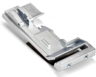
Mit dem Kräuselfuss und dem Differentialtransport wird eine Stofflage gekräuselt und direkt mit einem flach bleibenden Stoff vernäht. Der einzureihende Stoff liegt unter der Kräuselführung, wobei das flach bleibende Stoffteil auf der Kräuselführung liegt.
