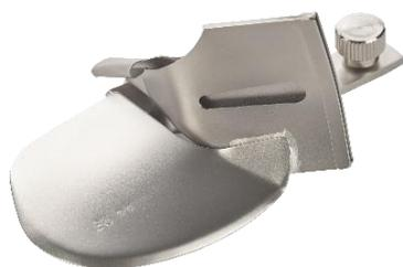
Mit dem Doppelfalten-Bandeinfasser lassen sich Stoffkanten und Halsausschnitte perfekt mit Band einfassen. Das ungefaltete Band wird durch die angebrachte Führungsschiene eingeführt, auf der oberen und unteren Seite des Schrägbandes doppelt umgeschlagen und mit einem Cover- oder Kettenstich angenäht. Für den perfekten Look kann das Band auch selbst angefertigt werden. Bänder von 36 mm Breite ergeben eine fertige Breite von ca. 10 mm.
