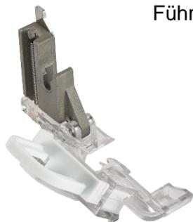
Der Paspelfuss XL wird an dem Nähfusshalter angebracht und eignet sich zum Herstellen und Einnähen von Paspeln. Es passen Kordeln bis zu einem Durchmesser von 10 mm durch die Führung.
