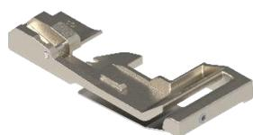
Mit dem Kräuselfuss und dem Differenzialtransport wird eine Stofflage gekräuselt und direkt mit einem flach bleibenden Stoff vernäht. Der einzureihende Stoff liegt unter der Kräuselführung, wobei das flach bleibende Stoffteil auf der Kräuselführung liegt.
