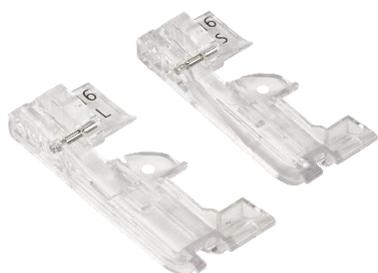
Der Paspelfuss eignet sich zum Herstellen und Einnähen von Paspeln. Die Nähfussmarkierung dient als praktische Führungshilfe. Fuss L16 S wird für leichte Stoffe für Paspeln mit einem Durchmesser von max. 3 mm verwendet. Fuss L16 L wird für mittelschwere und schwere Stoffe für Paspeln mit einem Durchmesser von 3 – 5 mm verwendet.
