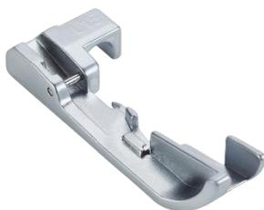
Mit dem Perlen- und Paillettenfuss können Perlen- und Paillettenschnüre von max. 6 mm Durchmesser schnell und einfach aufgenäht werden. Er wird für schöne Abschlüsse an Stoffkanten oder für Dekoration an Flachnähten verwendet. Die Rille an der Fussunterseite und der seitliche Führungskanal erfassen Perlen- und Paillettenschnüre optimal, sodass sie ohne Verrutschen vernäht werden können. In Kombination mit dem rechten Nahtführungslineal als Führungshilfe gelangen die Nähte besonders exakt.
